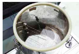
自然発熱性評価に使用する空気流通試験装置
