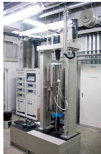
寿命診断用データ採取するための大型単軸クリープ試験機（最大荷重：200kN）
