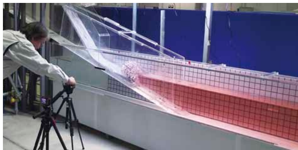
土石流による水面上昇実験の様子
