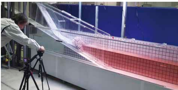
土石流による水面上昇実験の様子
