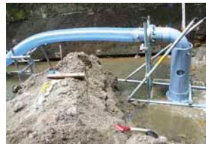
土砂の吸引実験の様子
