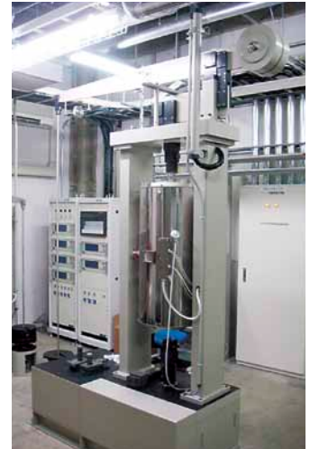
寿命診断用データ採取するための大型単軸クリープ試験機(最大荷重:200kN)
