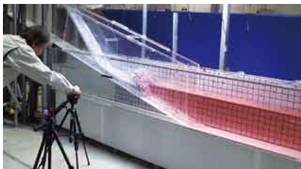
土石流による水面上昇実験の様子
