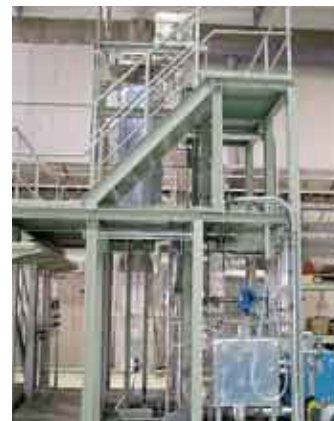
燃料の燃焼特性を測定する電気加熱式管状炉 (DTF: Drop Tube Furnace)
