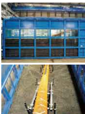
吸引方式排砂工法による土砂の吸引実験の状況
