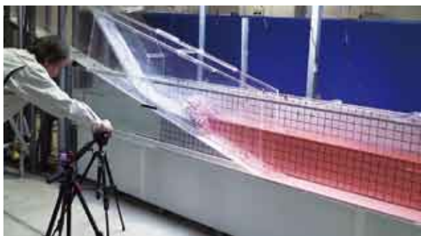
土石流による水面上昇実験の様子
