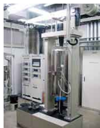
寿命診断用データを採取するための大型短軸クリープ試験機(最大荷重:200kN)
