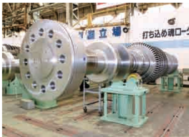
松島火力発電所(長崎県)高中圧タービンロータ
