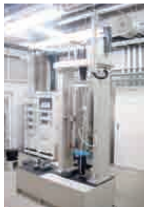
大型単軸クリープ試験機 (最大荷重: 200kN)
