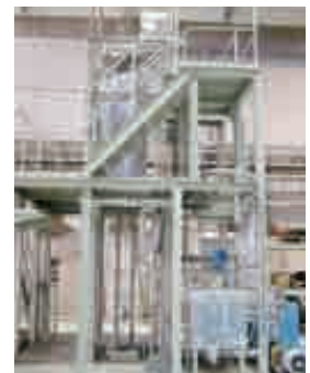
燃料の燃焼特性を測定する 電気加熱式管状炉 (DTF: Drop Tube Furnace)
