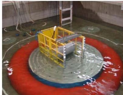
大型水中振動台による振動実験
