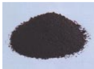
下水汚泥燃料(バイオソリッド燃料)
