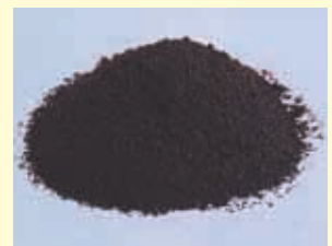
下水汚泥燃料(バイオソリッド燃料)
