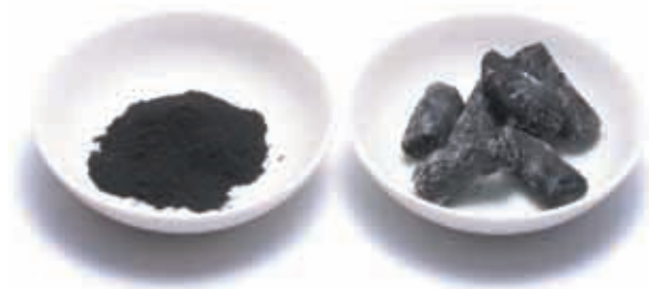
一般廃棄物炭化燃料 左：一般廃棄物から作られた炭化燃料 右：輸送や保管に便利ように炭化燃料を固めたもの
