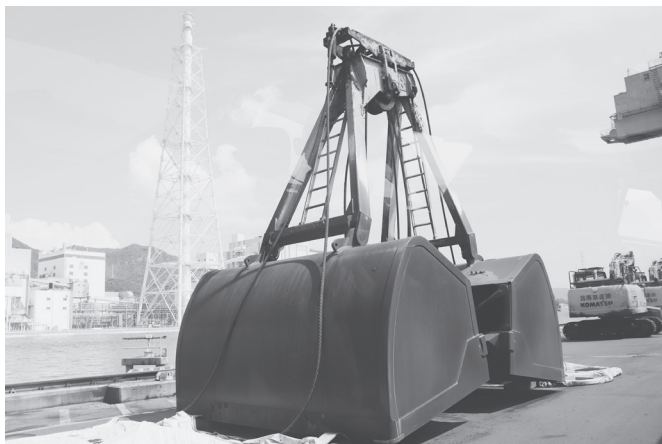
運ばれてきた石炭を掴むグラブバケット。周りの重機と比較してもその大きさがよくわかる
