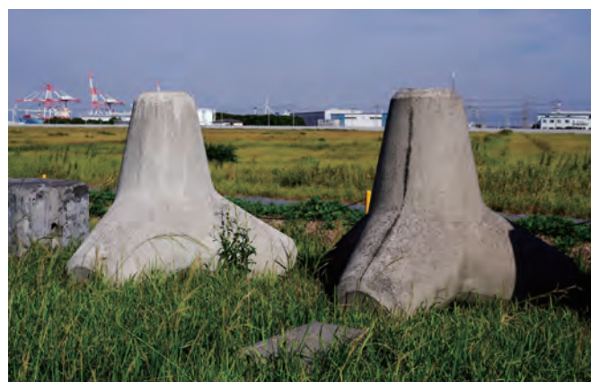
従来の消波ブロック(左)と「石炭灰重量モルタルブロック(右)」
