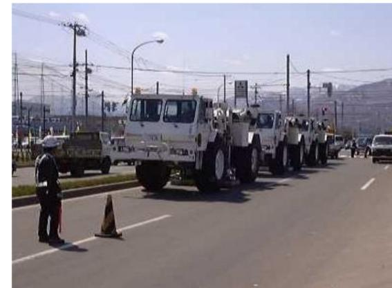
図3 起振車による発振状況(事例)
