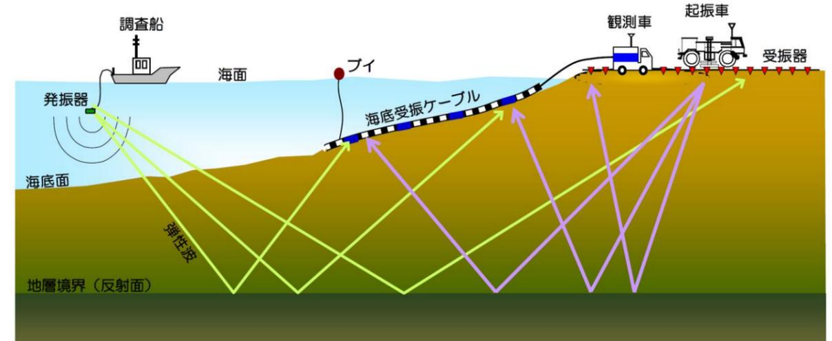
図2 弾性波探査概念図
