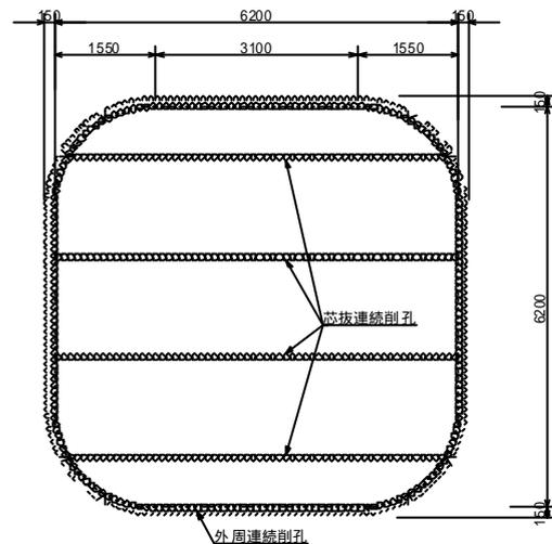
図 - 4 堤体穴あけ標準断面
