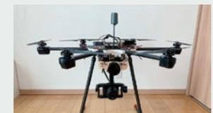
開発中の送電線点検ドローン
