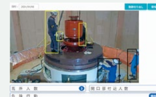
高所作業を検知した際のシステム画面
