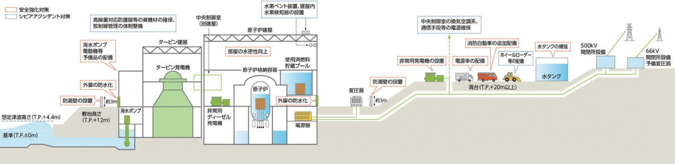
い、T.P. + 20m以上の高台に非常用発電機を設置します。
