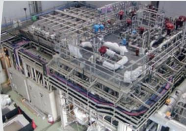
常圧150kW級のSOFCシステム
