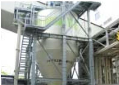
松浦火力発電所（長崎県）において下水汚泥燃料（バイオリッド）の混焼試験を2004年3月期から2006年3月期まで実施しました。2006年4月からは本格混焼を開始しています。
