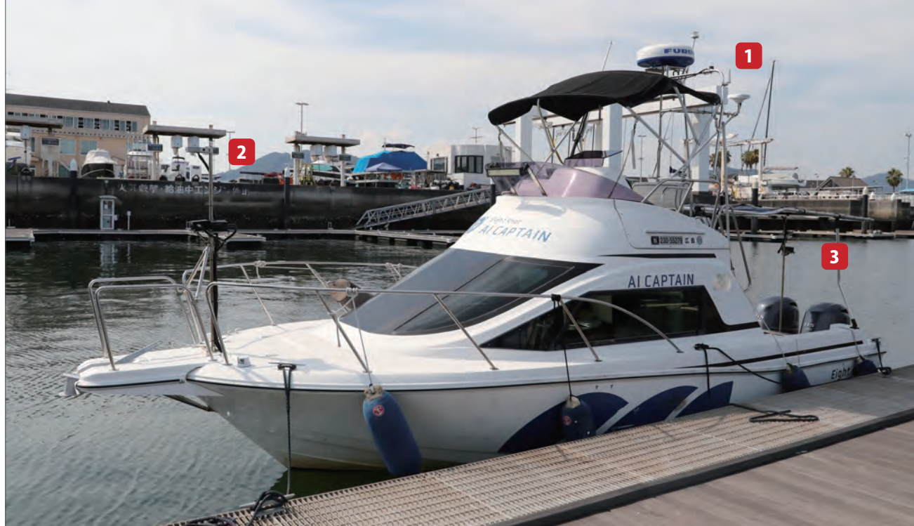
エイトノットが自律航行システムを開発するために購入したエイトノットワン（Eight Knot I）。電動船外機が2基あることで、大きな推進力を生み出すと同時に小回りが利き、船のコントロールが容易になる。 123については次ページで。
