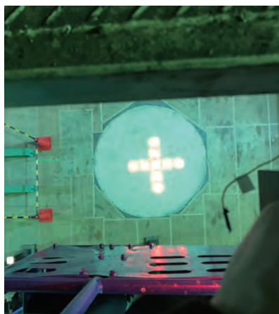
J-POWER新豊根発電所のクレーンにもホロライトを導入している(写真提供:パイフォトニクス)。
