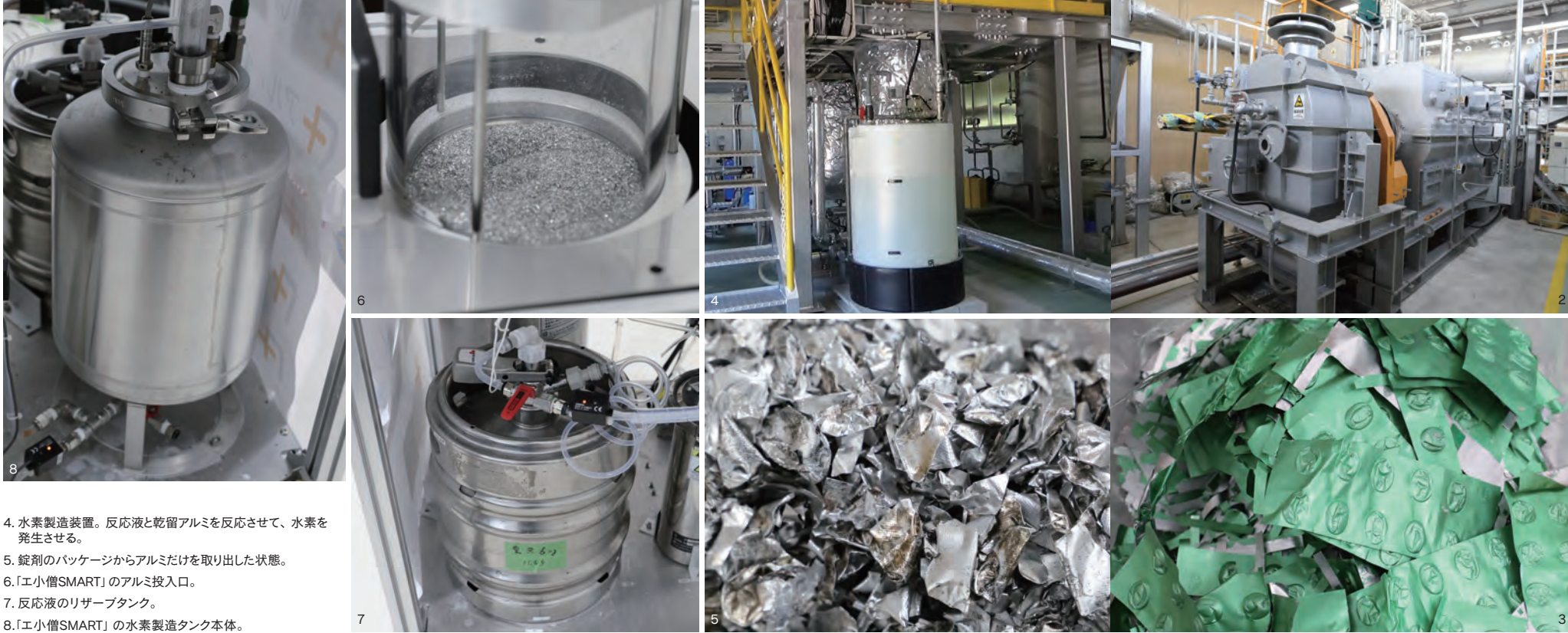
1. バルバー型分離機。水を使って、アルミ系廃棄物から紙バルブとアルミ付きプラスチックを分離する。 2. 乾留式アルミ回収装置。約600℃の熱でプラスチックを自然して除去して、アルミだけを取り出す。 3. 錠剤のパッケージは、プラスチックとアルミ箔でできている。
