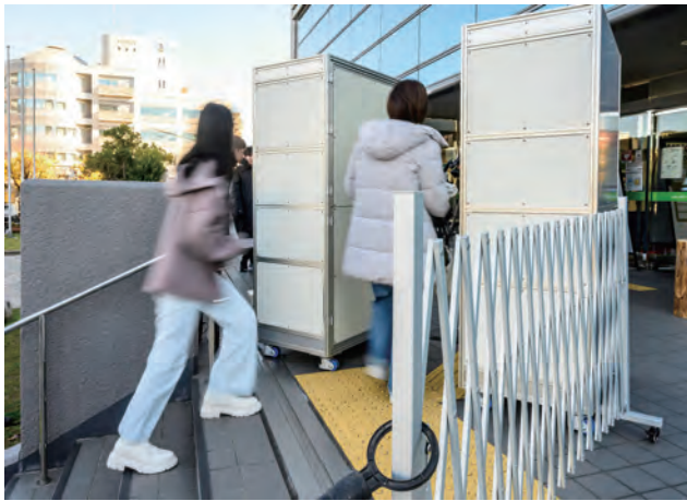
透視の科学を使ったウォークスルー型セキュリティシステム。バッグなどに隠された凶器などの危険物を検知し、瞬時に映像化する（ご本人提供）。
