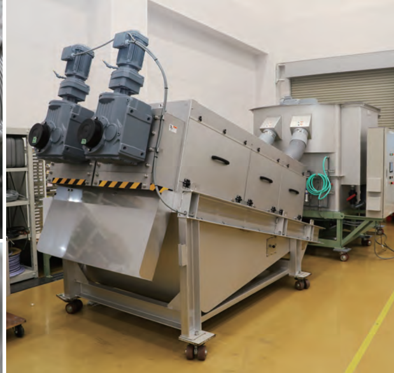
右／シリンダーを2本並べたタイプのヴァルト。シリンダーを斜めにするのは、脱水効率を上げるため。 左上／スクリューを入れる濾過体はリングを重ねて筒状のシリンダーを形成。 左下／シリンダーの内部。
