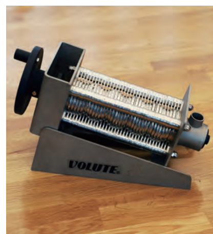
ヴァルードの仕組みを説明するための模型。スクリーユ羽根のエッジに接触したリングが可動する。
