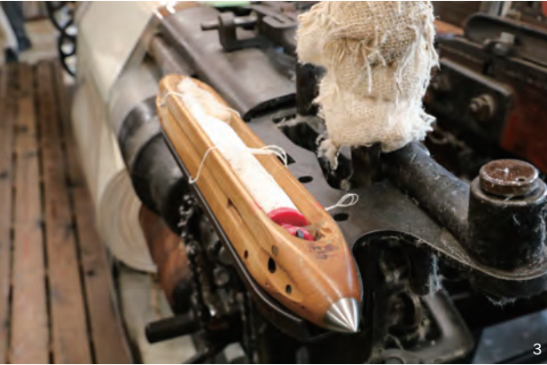
1. 1920～30年代につくられた10台（トヨタ製4台、スズキ製2台、遠州製4台）の織機が並ぶ工場。9台が1個のモーターで動いている。 2. タテ糸をセットする整経の工程。 3. ココ糸を通すためのシャトル。タテ糸が上下に交差する間を高速で左右に行き来する。シャトルは1丁、2丁……と数える。
