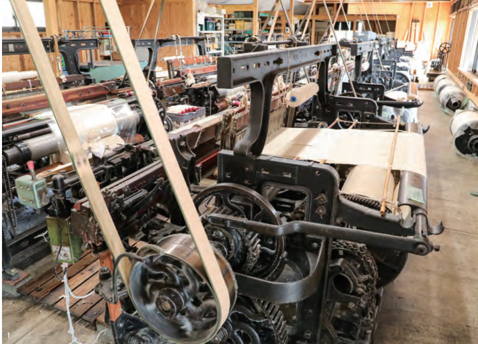
1. 1920～30年代につくられた10台（トヨタ製4台、スズキ製2台、遠州製4台）の織機が並ぶ工場。9台が1個のモーターで動いている。 2. タテ糸をセットする整経の工程。 3. ココ糸を通すためのシャトル。タテ糸が上下に交差する間を高速で左右に行き来する。シャトルは1丁、2丁……と数える。
