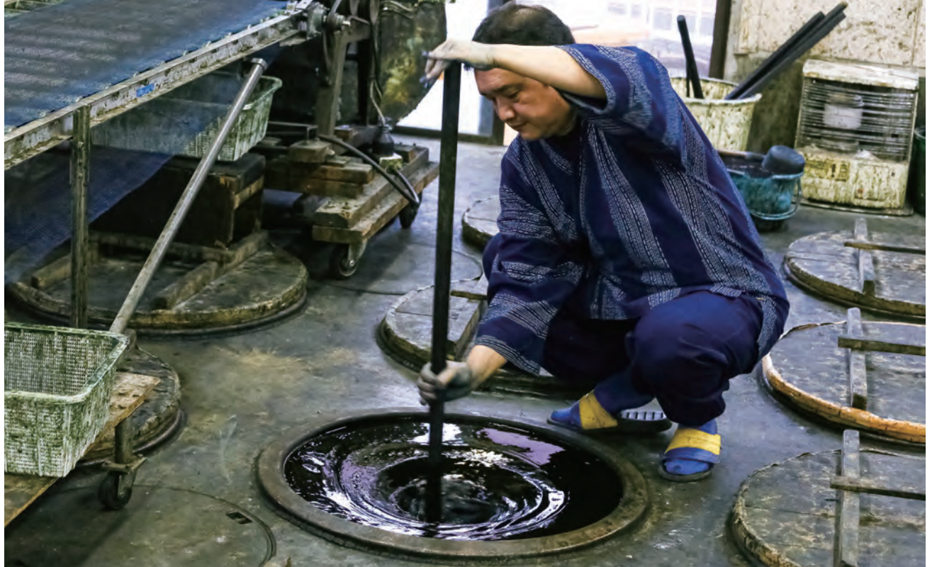
藍甕（あいがめ）を攪拌（かくはん）する作業。藍甕は常に25℃前後になるようヒーターで温められている。
