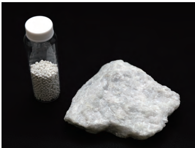
石灰石（写真右）を主原料にしてつくられた LIMEX Pellet（写真左）。
