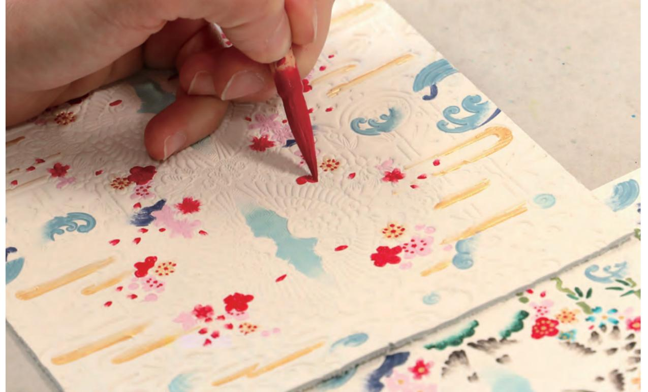
彩色の作業。プレス機で凹凸を付けた牛革に手作業で色を塗っていく。8色の塗料であらゆる色をつくり出す。
