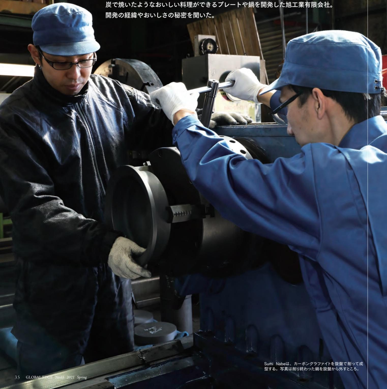
Sumi Nabelは、カーボングラファイトを旋盤で削って成型する。写真は削り終わった銅を旋盤から外すところ。
