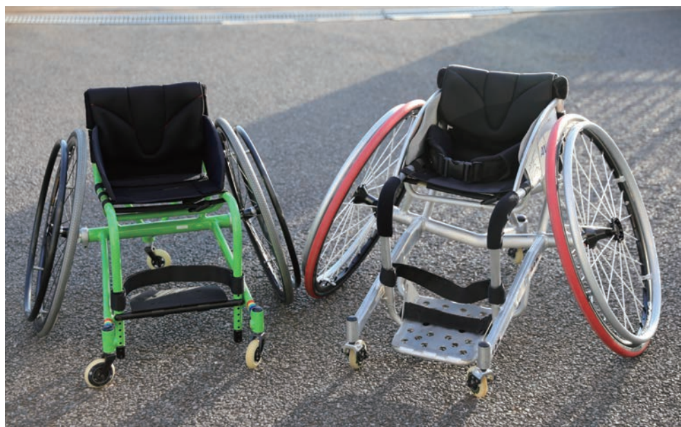
左側が子ども向けの競技用車椅子「WeeGo」。大人用の車椅子に比べてひと回り小さい車体は軽量で、子どもでも自由に操れる。
