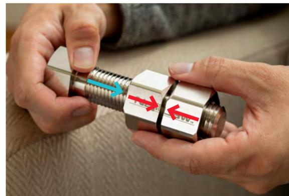
「L/Rネジ」の実物サンプル。特殊な3次元構造のネジ山を持つボルトに、右ネジのナットと左ネジのナットを連結して止めると、右ネジのナットが緩んでも左ネジのナットが逆方向の締まる方向に動き、決して緩まない。
