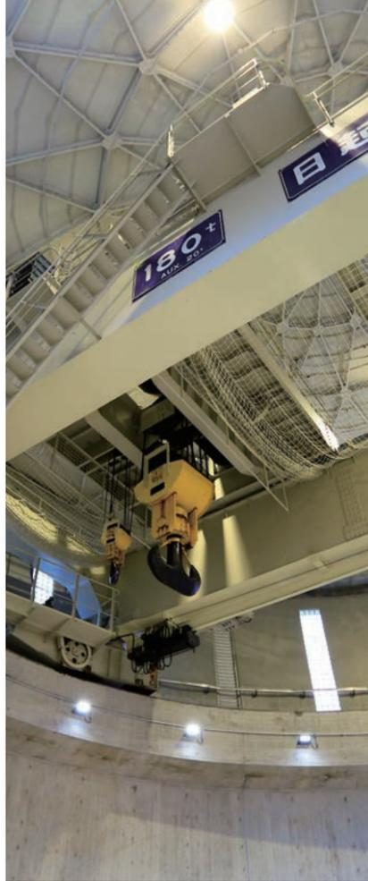
最大180トンの重量物を吊り上げることができる天井クレーン。
