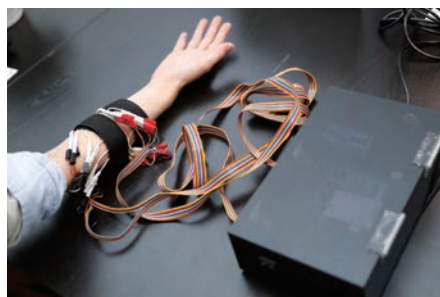
パソコンとUSBケーブルでつながれた本体を通して、腕に巻かれたベルトの電極パッドに電気信号が送られる。
