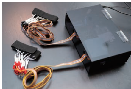
ポゼストハンドの多電極電気刺激キット。本体であるスイッチング基板や付属品の前腕ベルトなどが一式に。
