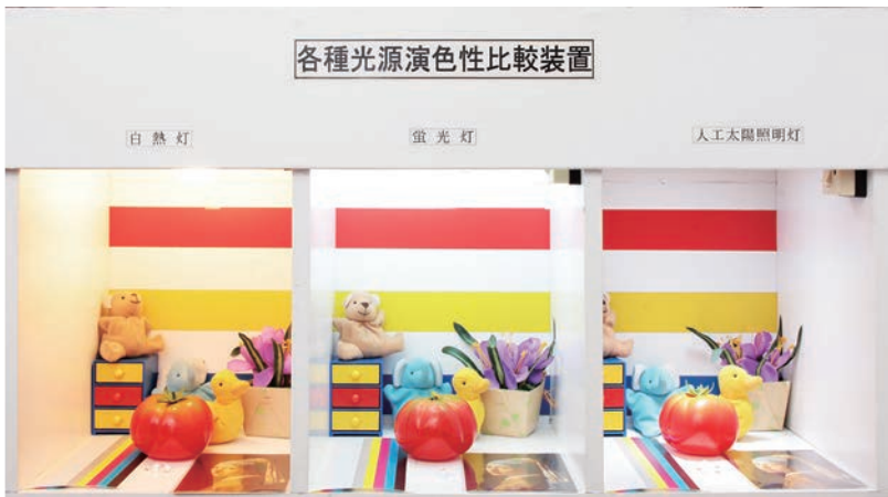
光源によって色が変わって見えることを示す比較装置。右:SOLAX、中央:蛍光灯、左:白熱灯。
