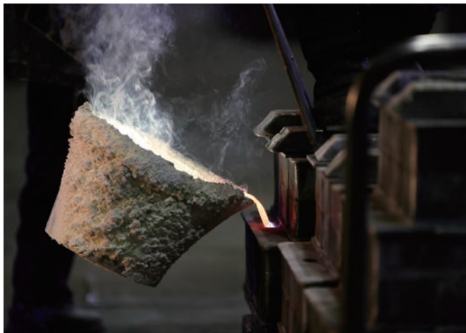
溶解した真鍮（湯）を流し入れているところ。熟練の技が必要。
