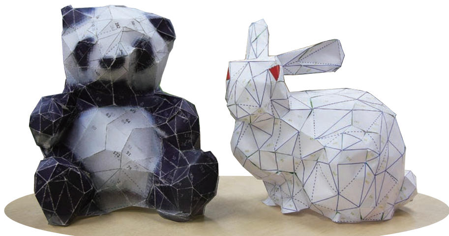
萩原氏らが開発した「折り紙式3Dプリンター」で作製した展開図を折ってつくったパンダとウサギ。展開図を折ることで、金型や特殊な機械を使わずに様々なものをつくることができる。
