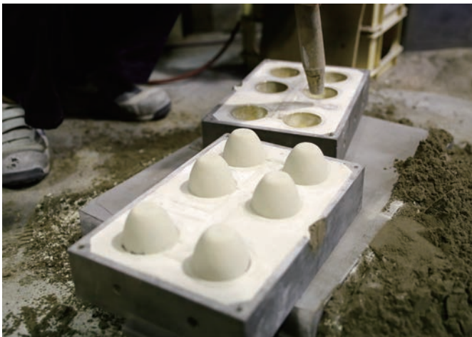
上下を合わせる前の砂型。アルミ枠の中に砂が詰められている。
