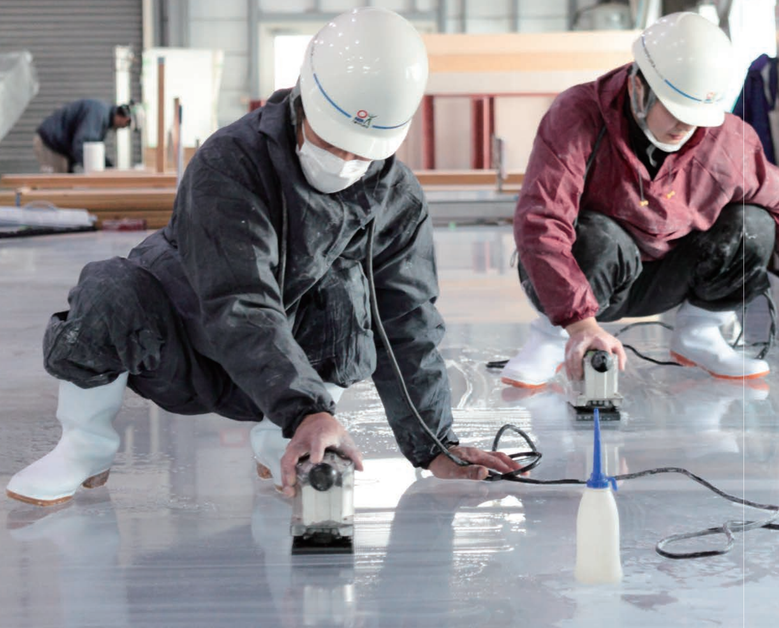
最終工程のアクリル板研磨作業。精度が約0.01mmレベルの研磨は、職人の手でしかできない。
