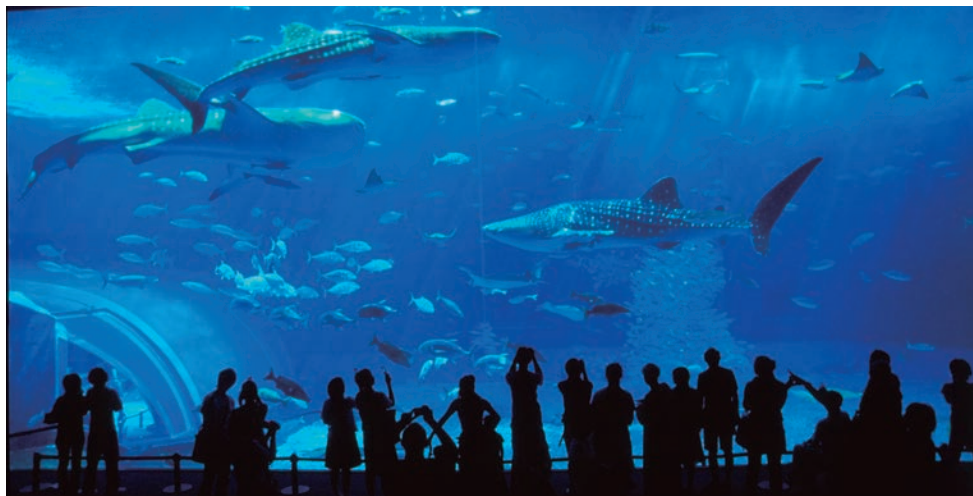
沖縄県にある美ら海水族館のアクアウォール。高さ8.2m×幅22.5m×厚さ60cm、総重量135tの巨大パネルだ。写真提供:日ブラ株式会社
