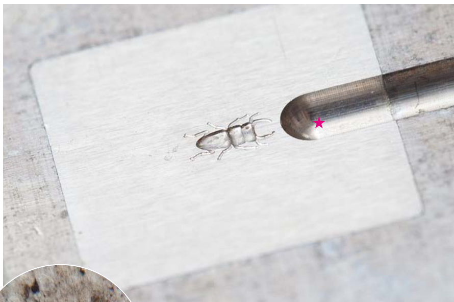
上・株式会社かいわ 代表取締役社長 山添重幸さん。 左・世界最小のプラスチック製マイクロオオクワガタフィギュアの金型。写真の★の部分は、溶けたプラスチックの流し込みルート。
