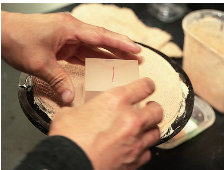
ピッチ板（研磨板）の上での手作業による研磨の様子。入社した社員がまずマスターする作業。
