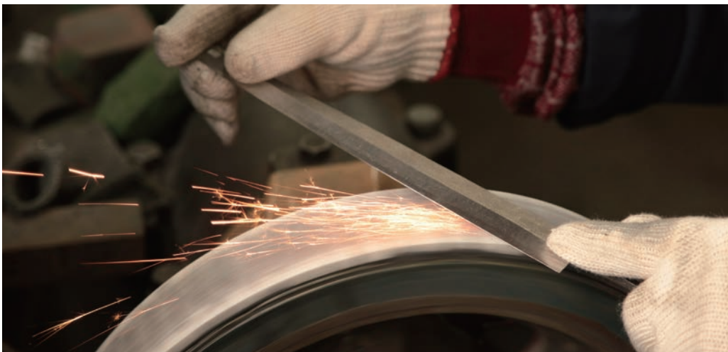
上・堺打刃物伝統工芸士 味岡知行さん。地元の工科高校や海外でも包丁づくりや包丁研ぎの指導を行っている。左・刃付けの作業では、回転研石やバフに押し当て、次第に目を細かくして包丁の形を削り出していく。
