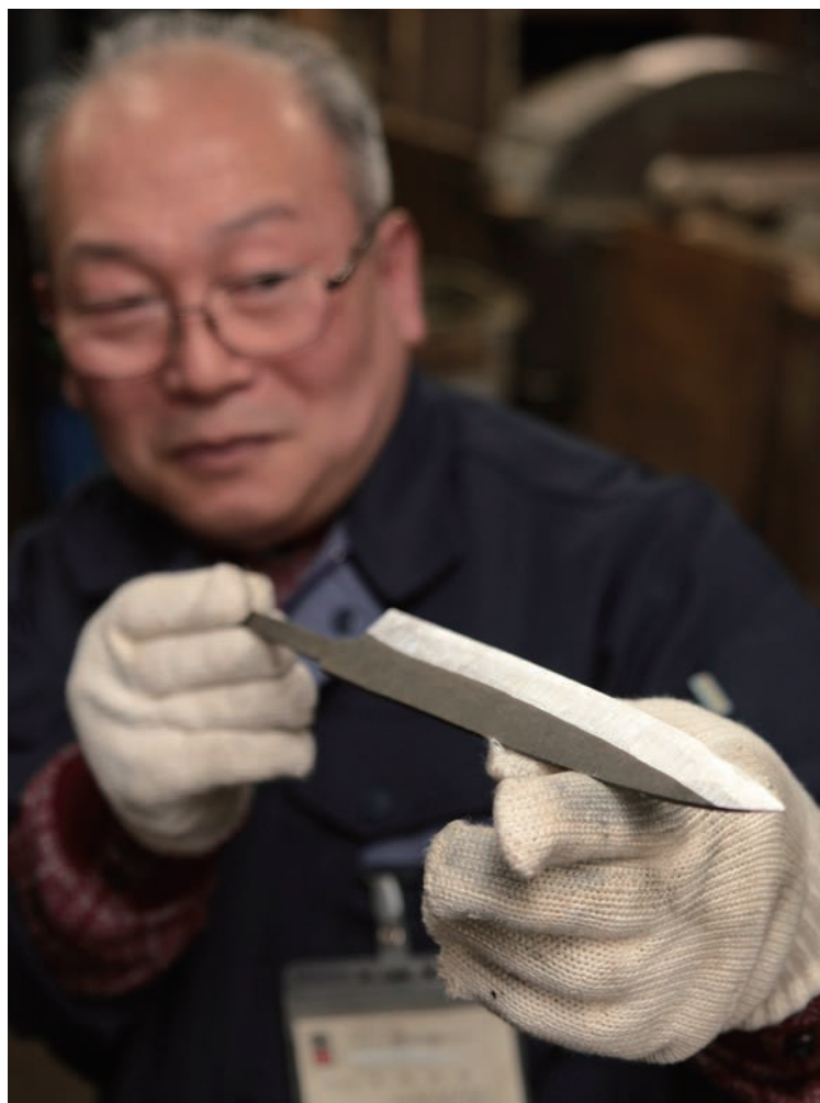
刃付けのポイントは「鉄の歪み」を取る。1本1本の性質を読み取り、削りながら歪みのない包丁に仕上げていく。
