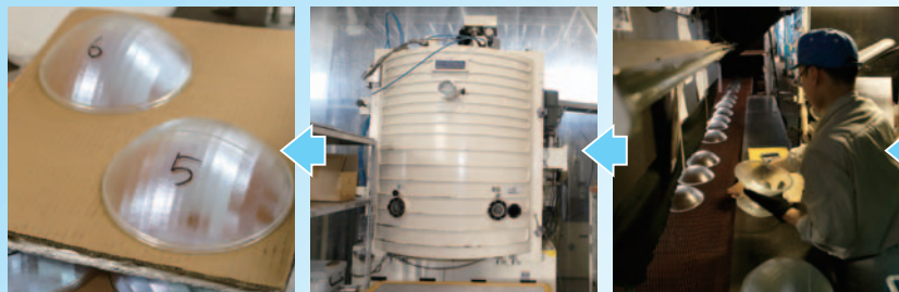
④ベルトコンベアーで工場内を回っているうちに冷えるので、その後検品。 ⑤真空蒸着機に入れて、表面に金属の膜をつくる。これによって光のコントロールが可能に。 ⑥できあがったデンタルミラー。最後の検品を経て出荷される。
