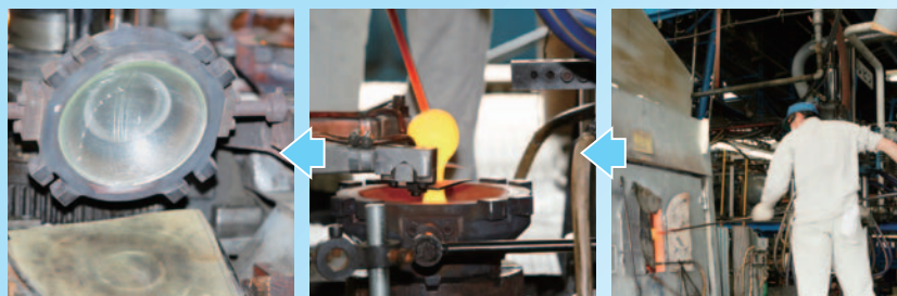
①ツボ炉から溶けたガラスを取り出す。温度はおよそ1,000℃。 ②金型にガラスを投入。上からも金型で押さえて成型する。 ③ある程度冷えたら、金型を回転させてガラスを取り出す。
