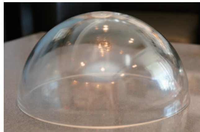
江戸っ子1号で使用されるガラスの半球。深度8,000mの水圧にも耐えられる強度を目指している。
