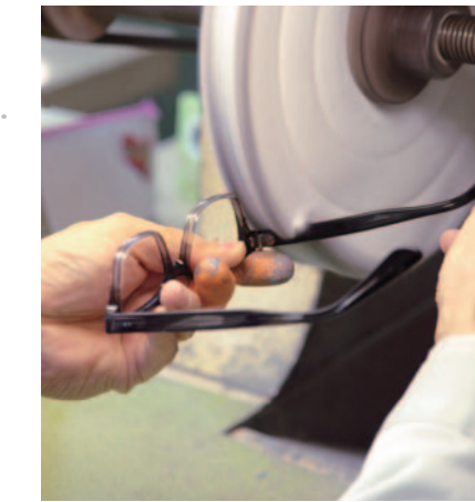
プラスチックフレームの研磨は、勘と経験が頼り。
