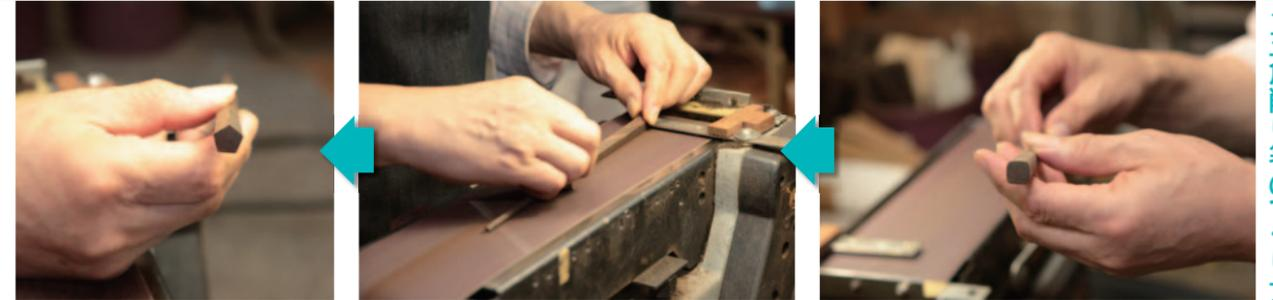
①材料の断面は四角形。この状態で材料屋から仕入れる。②グラインダーに押し当て、削っていく。③動と経験だけで正確な五角形の断面ができあがる。
