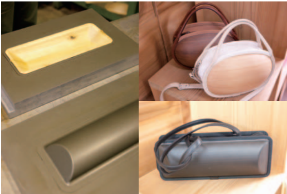
エコアス馬路村の木のバッグは、杉の間伐材を特殊圧縮加工してつくられる。
