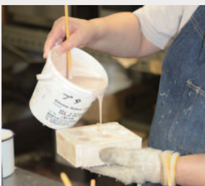
②つくった型の中に可塑性のビニール樹脂を流し込む。
