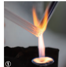
① ペン先用の透明な材料と持ち手用のカラーの材料をつなぎ合わせる。
