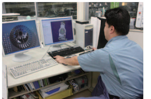
製品のデータはCADで管理され、事前に加工方法のシミュレーションを行う。
