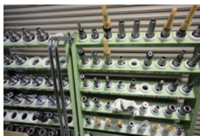
マシニングセンターの工具類。こうした複数の工具を自動的に取り替えながら、金属を切削加工する。
