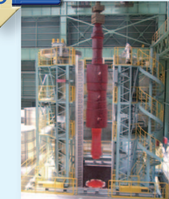
加熱・冷却して強度・靱性を付与
