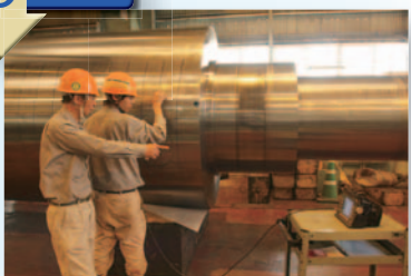
超音波で内部を検査
