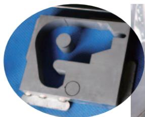
熱を上げないために、水中で切断するウォータージェット。左のように厚いチタン板を切断。
