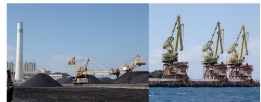
貯炭場は強風下でも石炭が飛散することはない。右は船から石炭を陸揚げするための揚炭装置。
