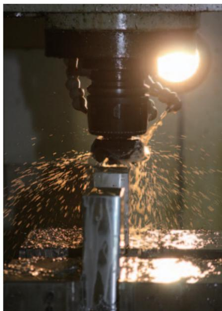
熱による酸化を避けるため、旋盤も水をかけながら、鉄よりもゆっくりと加工していく。
