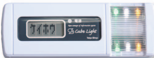
携帯型光受信器「キューブライト」。振動と文字表示のほか、音と光も出す。
