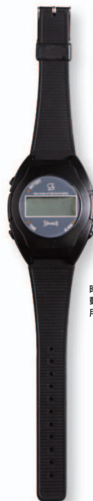
携帯型光受信器「キューブライト」。振動と文字表示のほか、音と光も出す。
