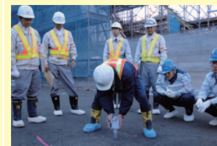
▲シュミットロックハンマーの反発度の実測
