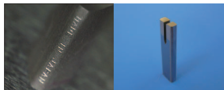
幅1ミリ、深さ20ミリほどの金属のくぼみの底に、0.2ミリの文字が彫られている。
