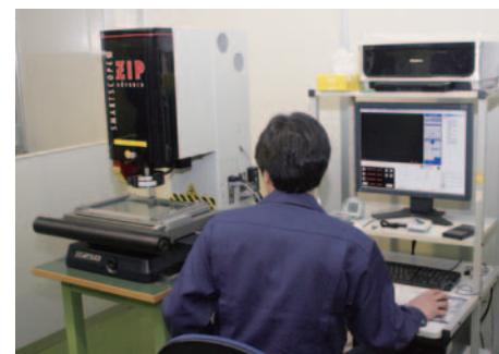
3次元測定器で全品検査し、精度をチェック。
