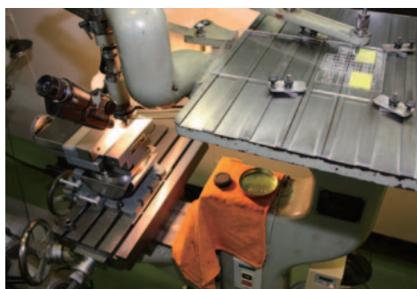
平面彫刻盤は、右のテーブル上の版下をトレースすると、左側のカッターが部品を彫る。
