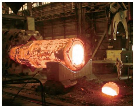
日本鍛造鋼で製造される蒸気タービンの軸。
